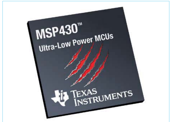
Bild 5. Benannt nach dem Superhelden Wolverine aus den X-Men-Comics setzt der Chip MSP430 von Texas Instruments neue Rekordmarken in Sachen Stromsparen: Weniger als 100 \mu\text{A}/\text{MHz} im aktiven Betrieb.
